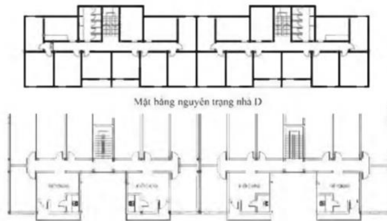
Hình 2.9. Mặt bằng kiểu hành lang giữa KTT Nguyễn Công Trứ và Kim Liên
